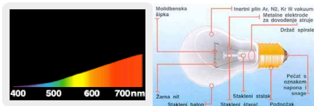
Slika 13.7 - Spektar zračenja i shematski prikaz standardne žarulje sa žarnom niti [13.4]
