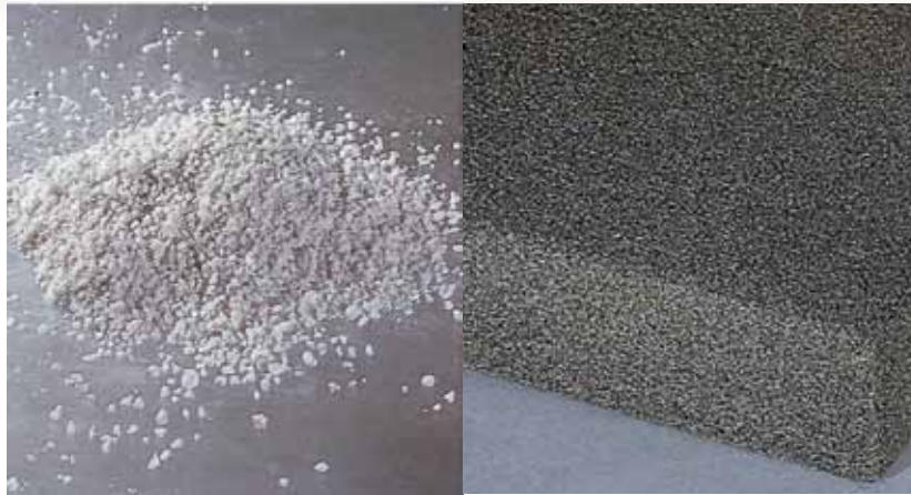
Slika 4.47- Ekspandirani perlit - nasip i pjenasto staklo - CG
