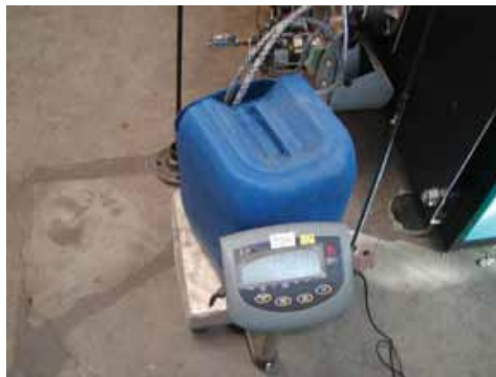
Slika 6.21 - Mjerenje potrošnje goriva vaganjem
