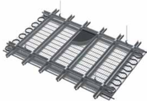
Slika 5.111 - Izvedba stropnog grijanja i hlađenja s perforiranim panelima iz gipsanih ploča za zvučnu izolaciju
