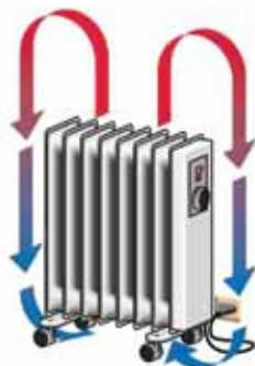
Slika 3.19 - Tipičan model slobodne konvekcije
