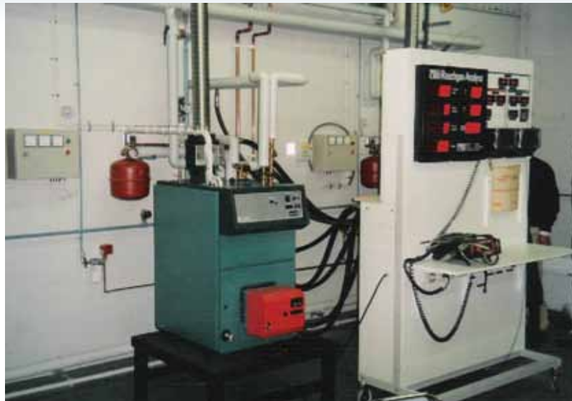
Slika 6.9 - Tipsko ispitivanje toplovodnog kotla
