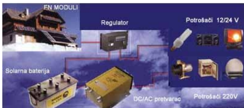
Slika 7.63 - Način spajanja fotonaponskog modula s potrošačima preko regulatora punjenja/pražnjenja baterije i DC/AC pretvarača
