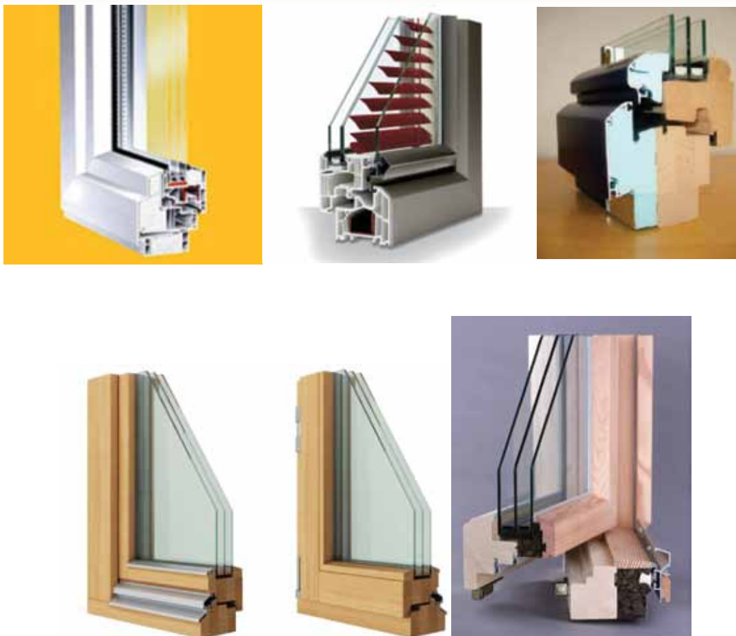
Slika 4.82 - Dodatno poboljšanje toplinskih karakteristika prozora može se postići s toplinskom izolacijom u profilu i/ili ugrađenim trostrukim izo staklom
