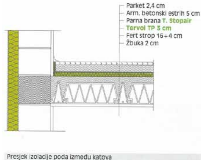
Slika 4.54 - Toplinska izolacija podne međukatne konstrukcije u svrhu zvučne izolacije topota, tzv. plivajući pod
