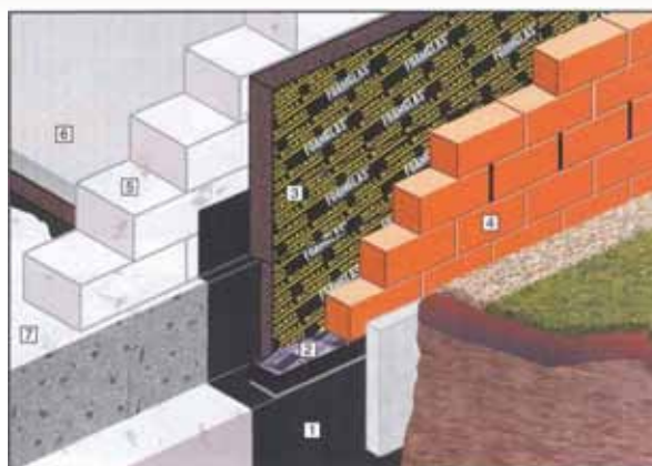
Slika 4.58 - Toplinska izolacija podnožja vanjskog zida pjenastim staklom
