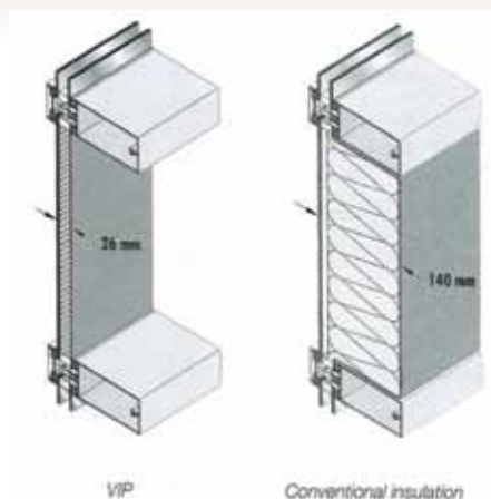
Slika 4.52 - VIP u sastavu lake fasadne ostakljene stijene i klasična toplinska izolacija istih karakteristika prolaska topline U = 0.26 \text{ W/m}^2\text{K}
