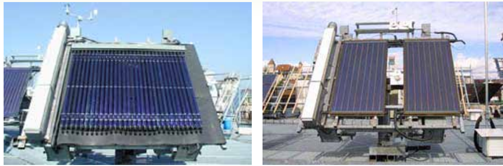
Slika 7.52 - Ispitna linija za mjerenje toplinskih karakteristika kolektora
