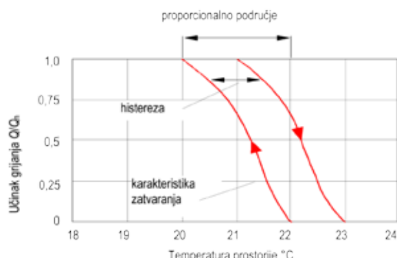
Slika 5.145 - Učinkovitost ogrjevnog tijela u ovisnosti o sobnoj temperaturi uslijed djelovanja termostatskog radijatorskog ventila
