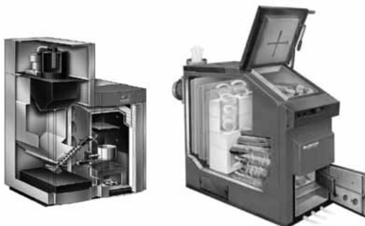
Slika 5.50 - Čelični kotlovi za biomasu: lijevo kotao s plamenikom na pelete; desno kotao s izgaranjem u fluidiziranom sloju [5.17]
