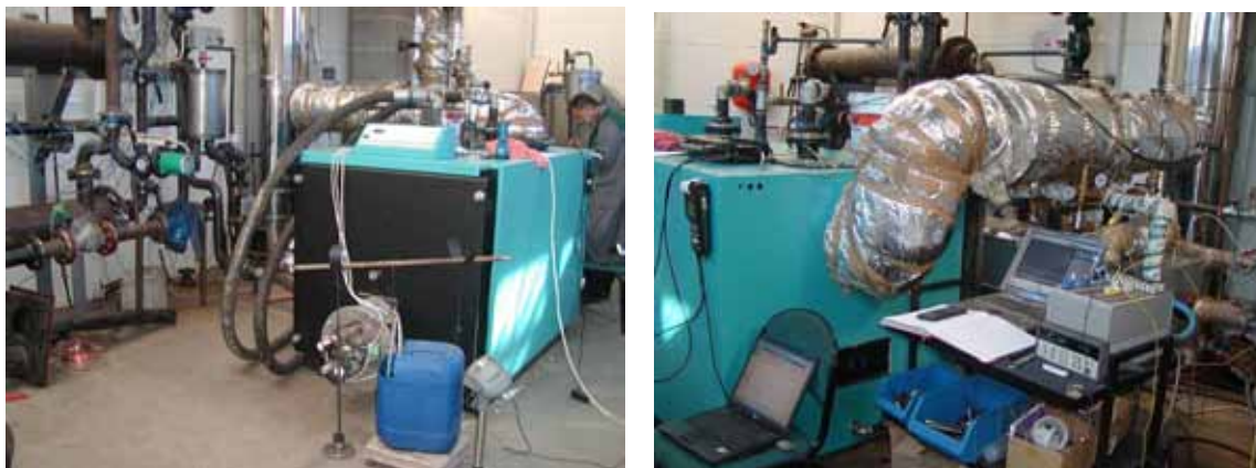
Slika 6.15 - Mjerenje potrošnje goriva, topline predane vodi i sastava dimnih plinova
