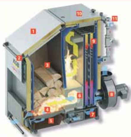
Slika 5.49 - Čelični pirolitički kotao na cjepanice [5.18]
