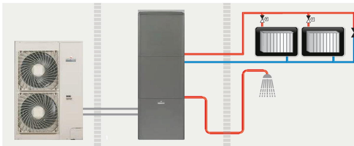
Slika 5.26 Predviđeni sustav s mogućnošću pripreme potrošne tople vode i grijanja
