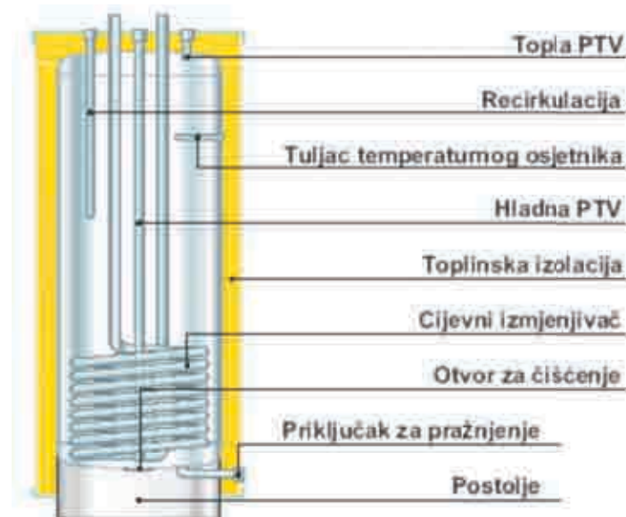
Slika 6.11. Spremnik PTV-a s cijevnim izmjenjivačem
