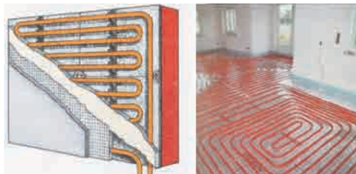
Slika 4.30. Zidni panel i cijevni podni razvod
