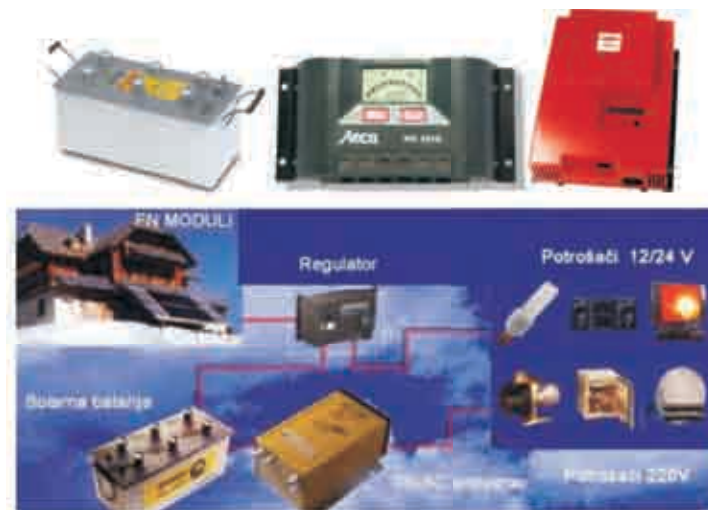
Slika 7.14. Način spajanja FN modula s potrošačima preko regulatora punjenja/praznjenja baterije i DC/AC pretvarača
