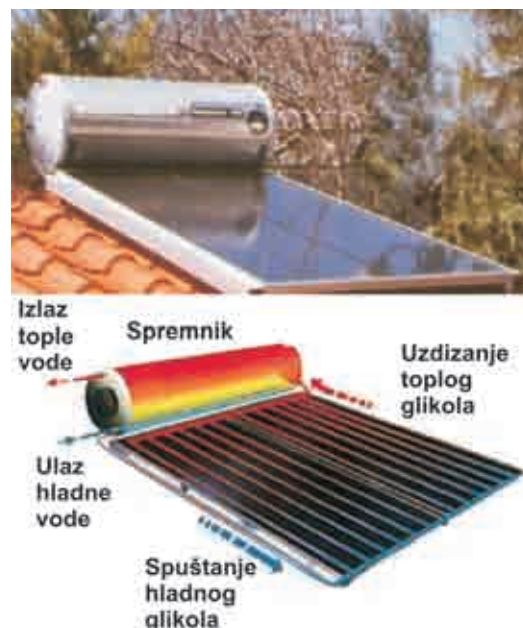
Slika 7.10. Solarni kolektor u paketu sa spremnikom s prirodnom cirkulacijom
