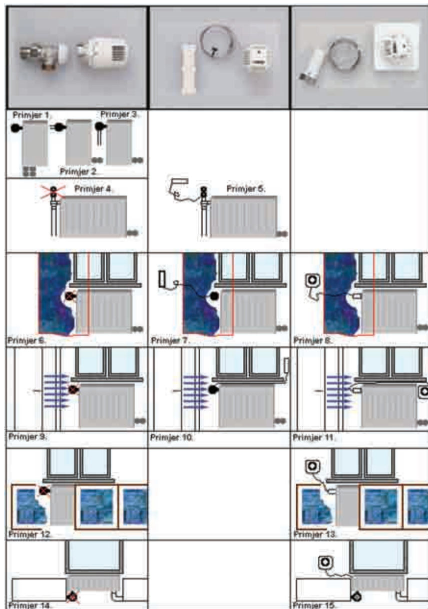
Slika 4.40. Postavljanje termostatskog ventila
