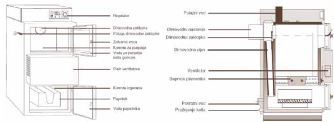
Slika 1. Vanjski izgled i presjek kotla na pirolizu
