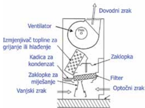
Slika 4. Shematski prikaz i presjek ventilokonvektora stojeće izvedbe
