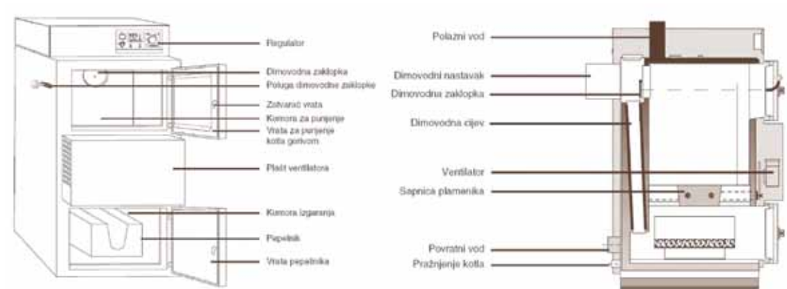
Slika 1. Vanjski izgled i presjek kotla na pirolizu
