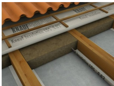
Slika 4. Presjek kosog krova s toplinskom izolacijom
