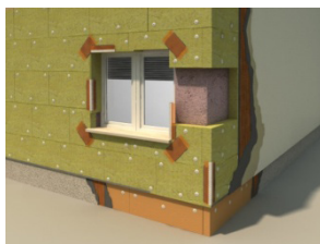
Slika 3. Presjek vanjskog zida s toplinskom izolacijom
