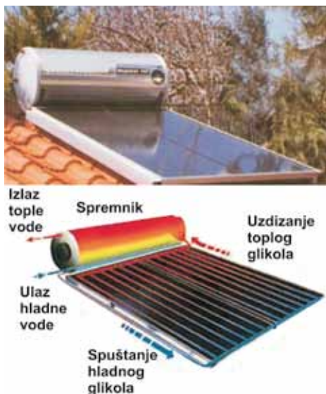
Slika: Solarni kolektor u paketu sa spremnikom s prirodnom cirkulacijom
