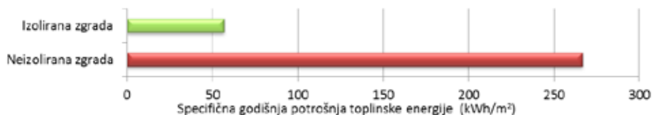
Slika: Usporedba potrošnje energije za grijanje izolirane prema teh. propisu i neizolirane obiteljske kuće od 150m 2
