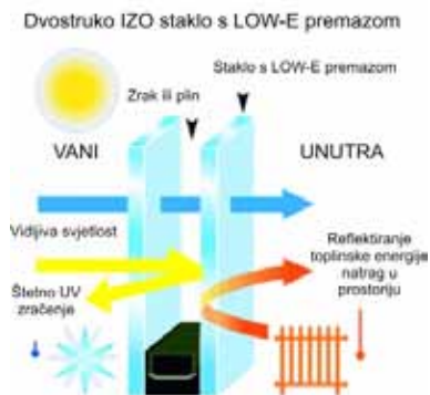
Slika: Dvostruko IZO staklo s LOW-E premazom
